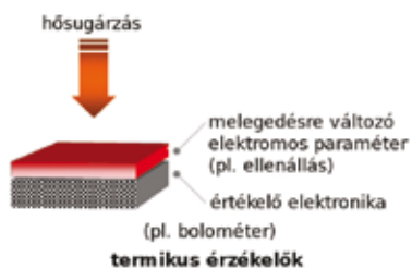
» 4. ábra. Termikus detektorok működése (ábra: PIM)
