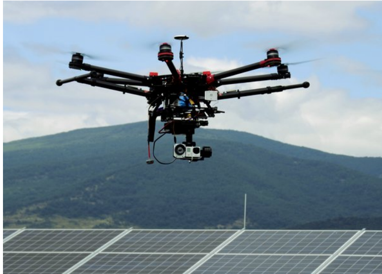
5. kép: 6-rotoros villamos drón kis méretű hőkamerával és videokamerával [K265]
